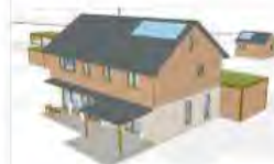
Maison commune Maison partagée de l'eco-hamenu du plessis comprenant: une salle polyvalente, un atelier, un bureau, des chambres d'amis Ossature bois et isolation paille MOA ASL ecohamenu du Plessis Mission partielle permis de construire en collaboration avec l'agence RD architecte Région centre
